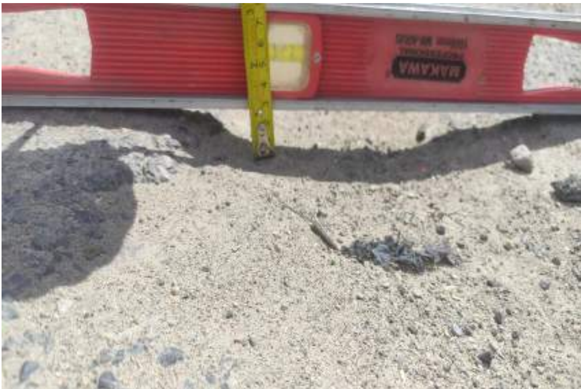
Figura 85. Falla denominada "hueco" en la muestra número cuatro
