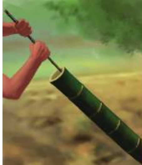
Figura 06. Perforación de cañas
