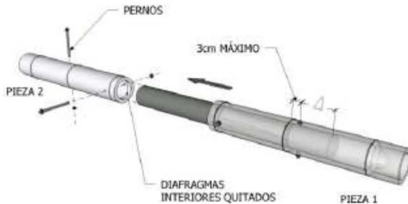
Figura 22. Empalme de 2 bambúes mediante una pieza de madera.
