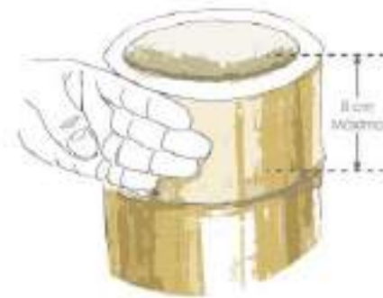
Figura 14. Separación máxima del nudo
