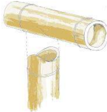
Figura 16. Unión típica de boca de pescado
