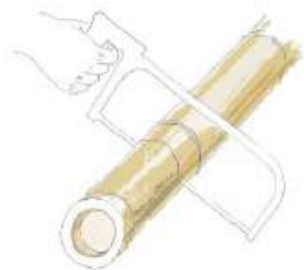
Figura 15. Corte perpendicular a las fibras
