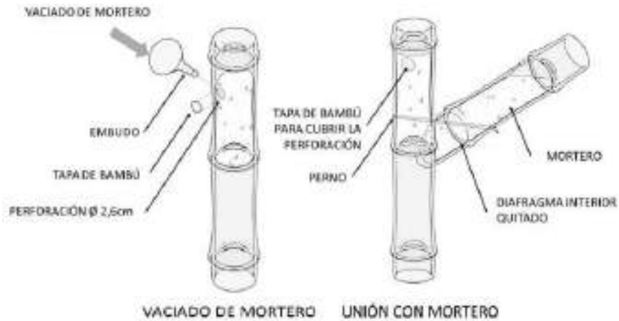
Figura 27. Vaciado de mortero y unión de los culmos con mortero Fuente: NEC-SE-GUADÚA (2016)
