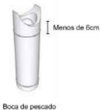
Figura 31. Corte tipo "Boca de Pescado"
