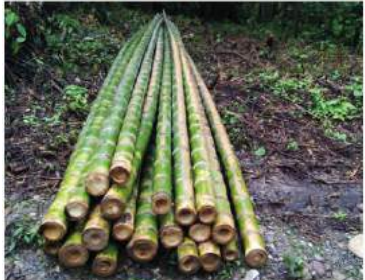
Figura 12. Cañas de primera de 8 m de longitud y 10 cm de diámetro.
